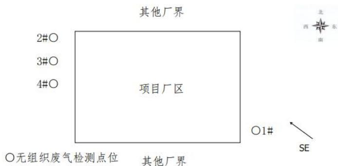
图4 废气监测布点示意图
